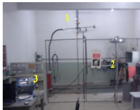
Figura 1. Sala em que foram realizados os três primeiros experimentos. 1. Isolador; 2. Antena; 3. Analisador de espectro.
