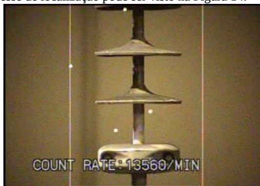
Figura 7: Primeiro frame capturado no ensaio do isolador velho com anel.
