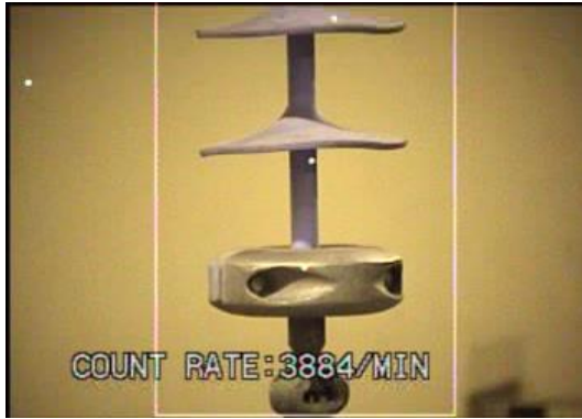
Figura 9: Primeiro frame capturado no ensaio do isolador novo com anel.
