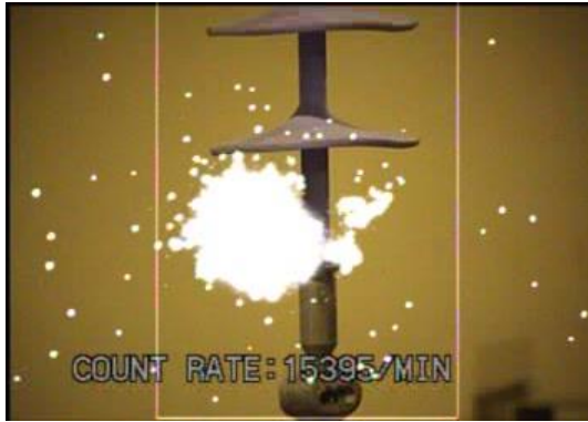
Figura 6: Primeiro frame capturado no ensaio do isolador novo sem anel equalizador.
