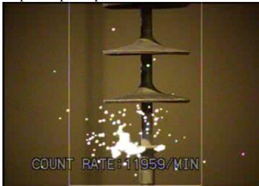
Figura 11: Primeiro frame capturado no ensaio do isolador velho sem anel.
