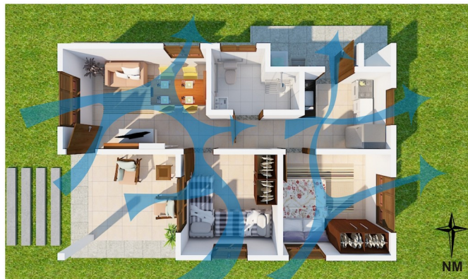
Fig. 2. Planta de layout com indicação do fluxo dos ventos predominantes
