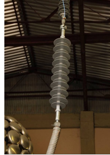
Figura 1: Método de Fixação do Isolador para Ensaio
