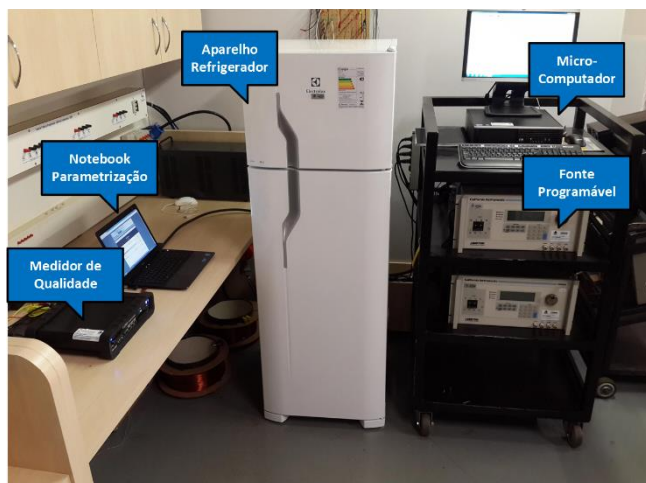
Figura 6. Estrutura laboratorial para a reprodução de fenômenos característicos de distúrbios na rede de suprimento.
