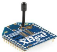
Fig. 6. Módulo de comunicação Xbee-pro baseado na tecnologia Zigbee .
