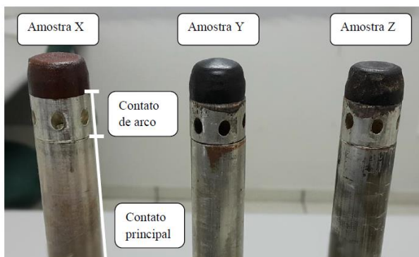
Figura 6 – Amostras de contato móvel do disjuntor.
