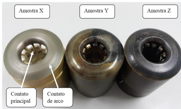
Figura 5 – Amostras de contato fixo do disjuntor.
