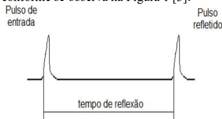
Figura 1. Tempo entre o pulso de entrada e o pulso refletido.
