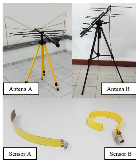
Figura 2. Fotografias dos sensores utilizados para captar os sinais eletromagnéticos irradiados.
