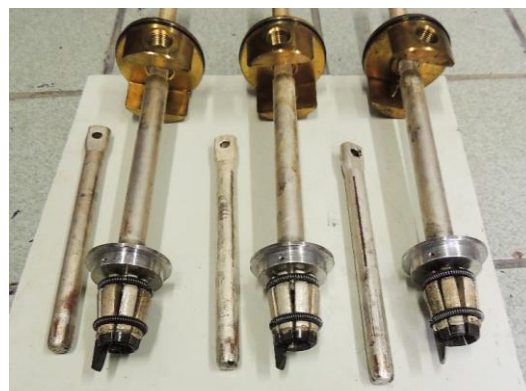
Figura 1. Fotografia dos contatos fixos e móveis do disjuntor ensaiado.
