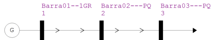
Figura 6 - Topologia do sistema de 3 barras – Caso 2
