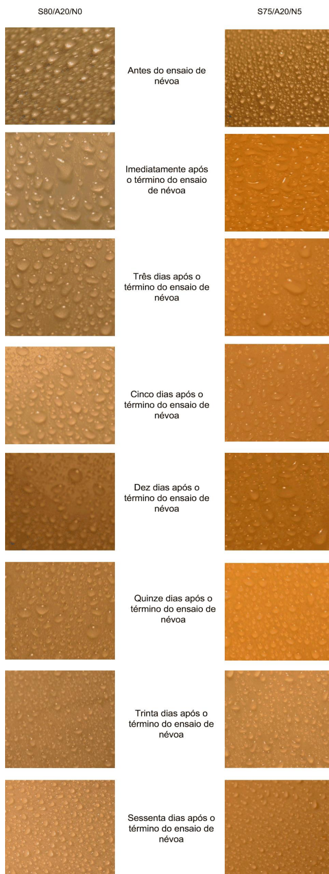
Fig. 9. Amostra dos revestimentos investigados para classificação da hidrofobicidade, em diferentes instantes de tempo, segundo o método STRI.
