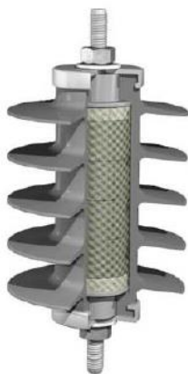
Figura 1. Representação gráfica do para-raios de ZnO.
