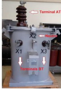
Fig. 1. Transformador monofásico de 10 kVA, 7,967 kV/240-120 V, com secundário em tape central.
