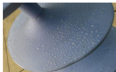
Figura 4. Foto do isolador logo após ser submetido à poluição artificial.
