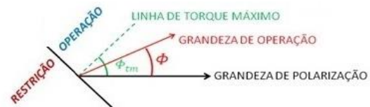
Fig. 1. Operação da proteção direcional.
