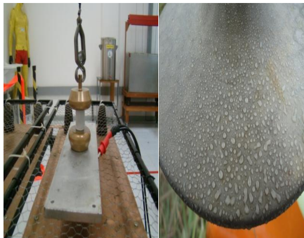
Figura 06 – Ensaios químicos e mecânicos em isoladores.
