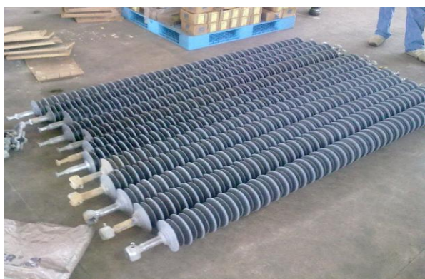
Figura 01- Isoladores poliméricos sem gestão.
