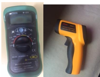
Figura 5. Aparelho medidor multifunção IP-233 (Impac) e termômetro infravermelho Ufree GM300 (CE).
