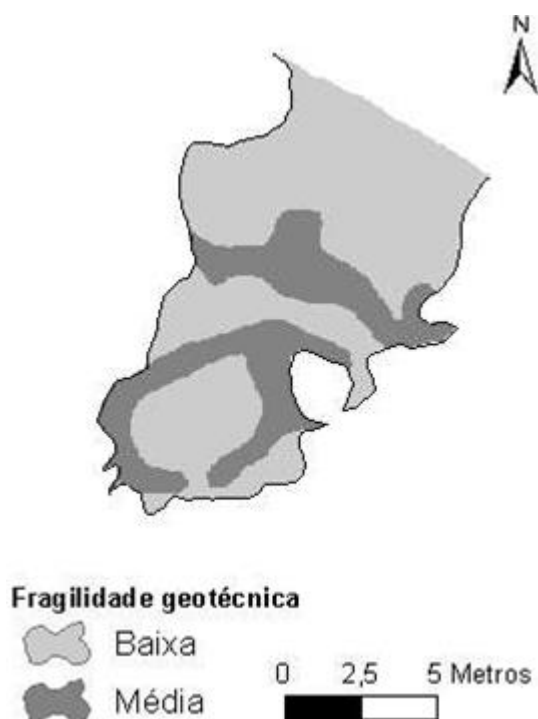
Figura 5. Zoneamento da fragilidade geotécnica da caverna SPB10.
