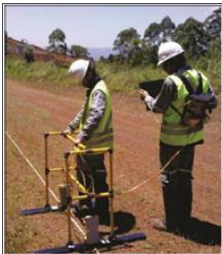
Figura 2: Levantamento GPR em campo.
