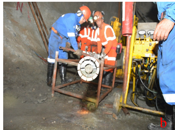
Figura 3. Foto ilustrando ensaios dispensados por problemas envolvendo não centralização do furo (a) e quebra do testemunho após sobrefuração (b).
