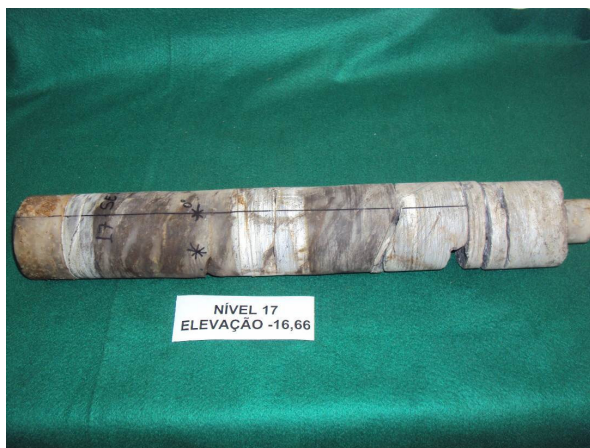
Figura 5. Acima, um exemplo de registro dos dados (ensaio no N11) e, abaixo, um testemunho empastilhado durante a execução da sobrefuração (ensaio no N17).
