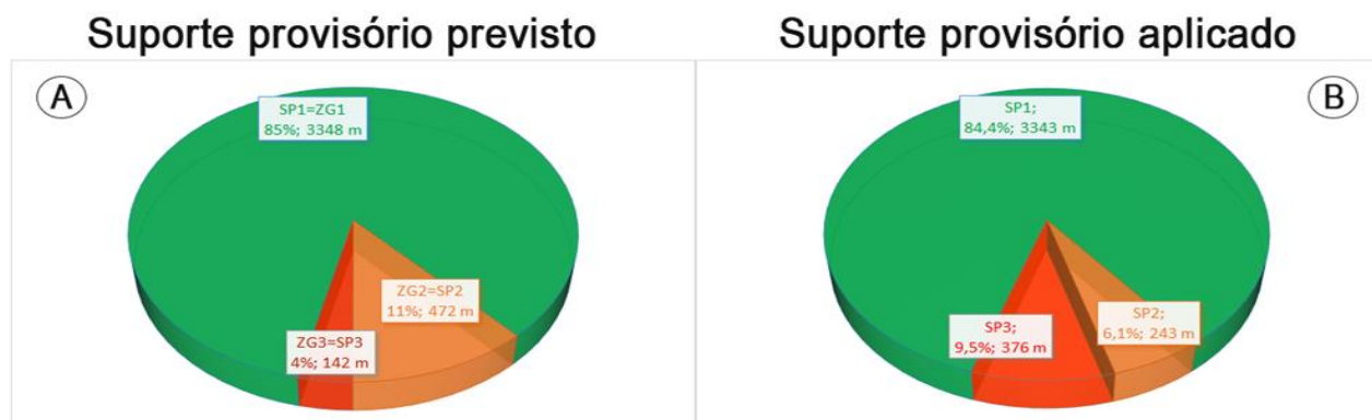
Figura 7 - Percentagens de suporte provisório previstas em fase de obra em função do zonamento (A) e as realmente efetuadas (B)
