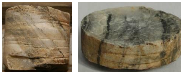
Figura 5. Exemplos de ocorrência de discing com diferentes relações angulares, \alpha , entre o eixo do furo e o plano de anisotropia (Sb).
