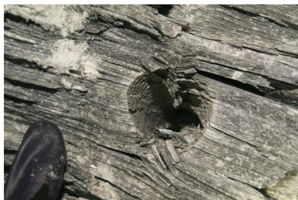
Figura 3. Exemplo de quebra dos planos de foliação na parede de um furo de detonação feito paralelo à anisotropia do maciço.
