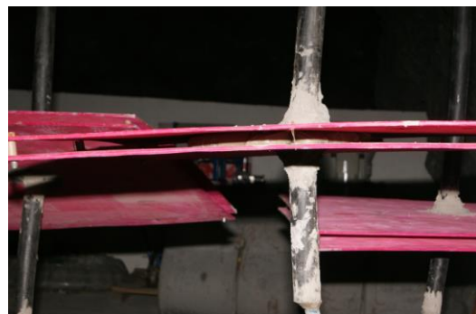
Figura 19: Comportamento da mistura ligante quando contendo o aditivo, permitindo o preenchimento subsequente do restante do furo.
