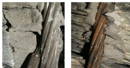
Figura 7: Comparação da textura entre os diferentes traços. (a) Textura referida a tabela 1; (b) textura do traço modificado para W/C de 0,45.
