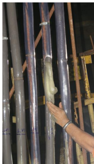
Figura 14: Arranjo com tubos transparentes para realização de simulação para o processo de cabeamento.
