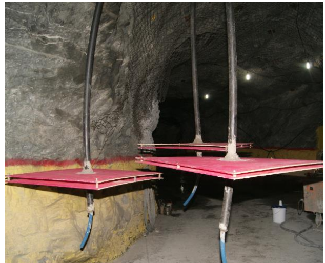
Figura 18: Arranjo realizado para simular o efeito do aditivo tixotrópico quando em situações de trincas no maciço rochoso.
