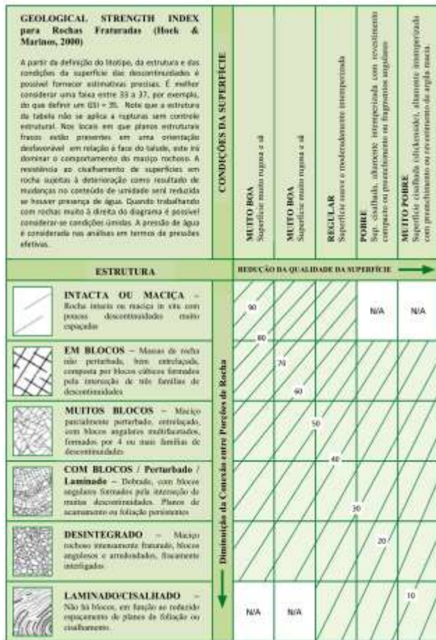
Figura 1. Ábaco da classificação GSI.
