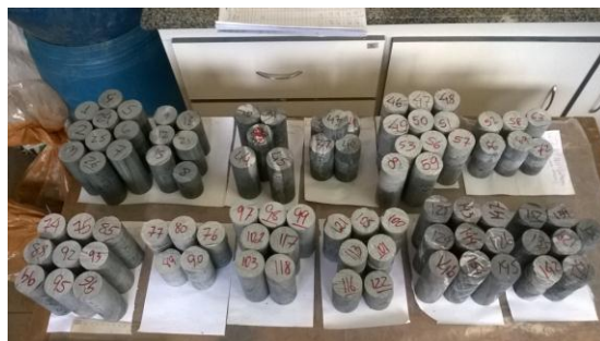
Figura 1 – Preparação de amostras para realização de ensaios de dureza de Schmidt e resistência à compressão uniaxial.
