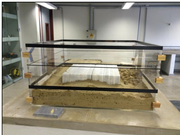
Figura 6: Tanque de acrílico preenchido com areia. O modelo reduzido se encontra enterrado no tanque. Atenção aos reforços nas paredes da caixa.
