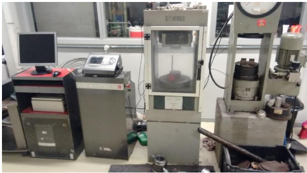
Figura 1. Prensa servo-controlada da marca Controls utilizada nos ensaios de compressão triaxial e uniaxial.
