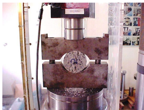
Figura 4. Ensaio de compressão diametral com Gr.
