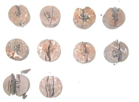
Figura 5. Corpos de prova ensaiados com a BB.
