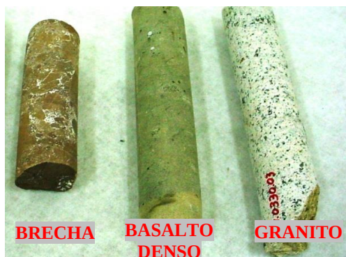
Figura 2. Testemunhos de brecha basáltica, basalto denso e granito.
