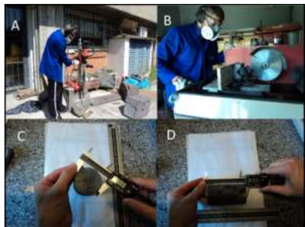
Figura 3. (A) extração de amostras com perfuratriz; (B) preparação dos corpos de prova; (C) medida de diâmetro; (D) medida de altura.
