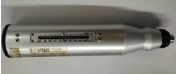
Figura 1. Esclerômetro de Schmidt
