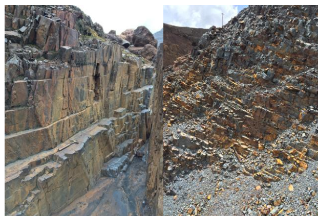
a) b) Figura 9 – Hematititos compactos da mina do Sapecado, a) HC2 com RQD bom e b) HC1 com RQD ruim.
