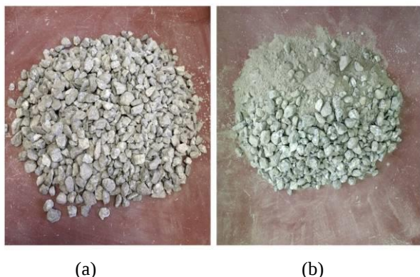
Figura 3.5. Amostras do ensaio de desgaste por abrasão Los Angeles: (a) antes; (b) depois.
