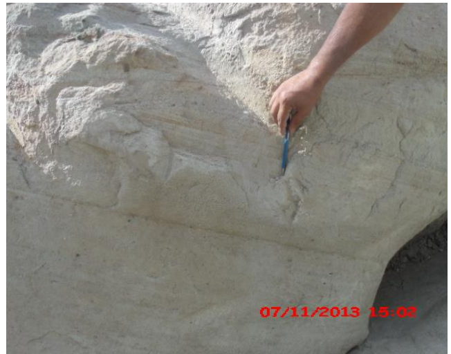
Figura 6. Estratificação cruzada com presença de areia grossa mal selecionada típica de fácies fluvial.
