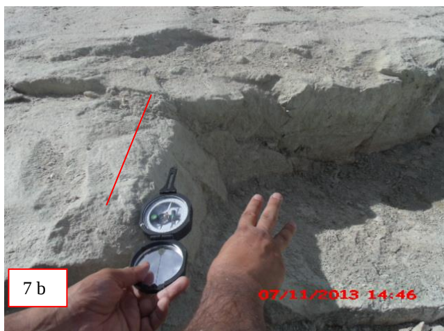
Figuras 7a (acima) e 7b (abaixo) – Famílias de Fraturas F2 (a) e F3 (b) identificadas no arenito da fundação do vertedouro entre os Blocos 13 e 17.
