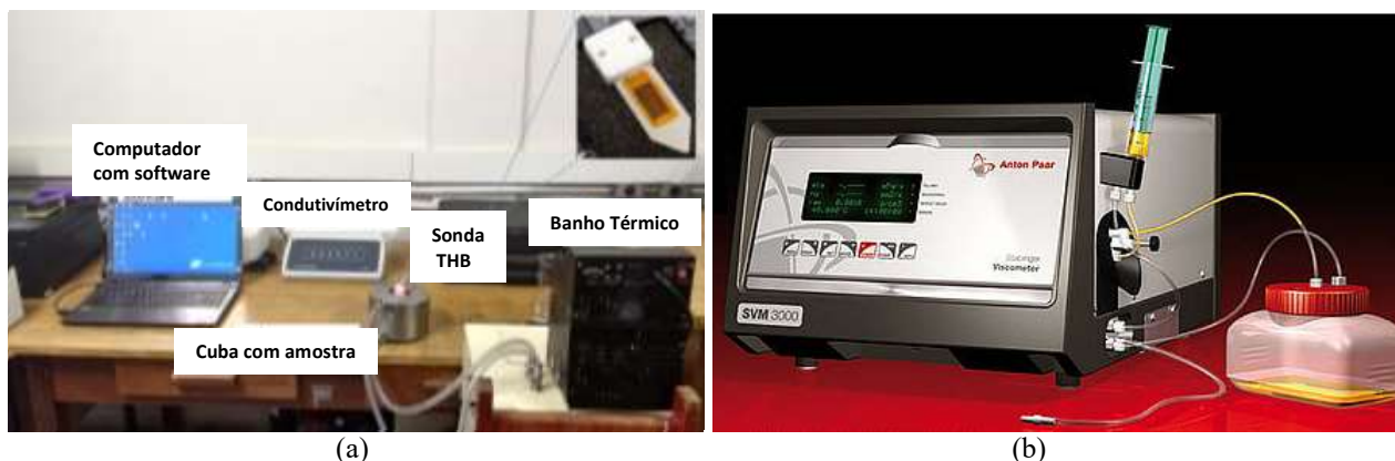
Figura 2: (a) - aparato experimental de medição de condutividade térmica, (b) imagem do viscosímetro SVM 3000.
