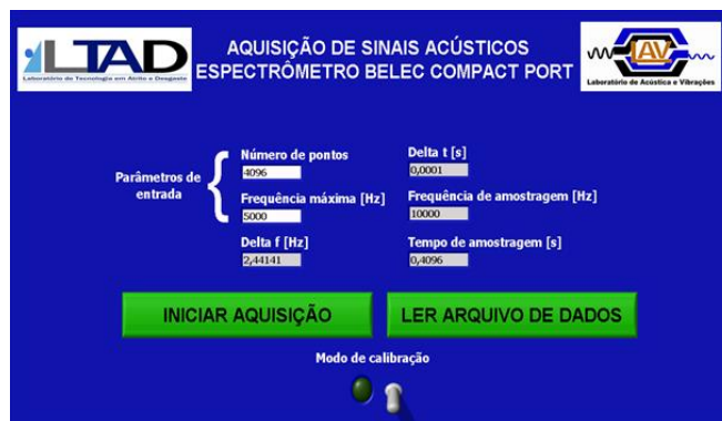
Figura 2: Interface Homem Máquina do programa de aquisição de dados programado na plataforma LabVIEW®.
