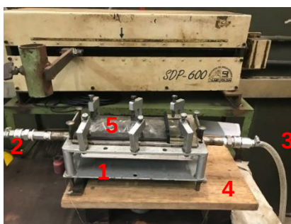
Figura 3. Sistema com mesa utilizada nos experimentos: 1- Calorímetro, 2 - entrada de água vinda do reservatório, 3 - Saída de água, 4 - Suporte, 5 - Placa teste
