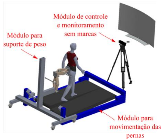
Figura 1: Imagem conceitual da estrutura HOPE-G, contendo: módulo para suporte do corpo; módulo para movimentação dos membros inferiores; e sistema de controle e monitoramento sem marcas.
