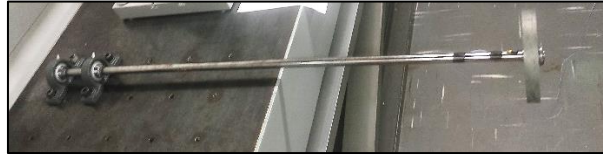
Figura 2: Sistema eixo-disco-mancal utilizado nos procedimentos experimentais
