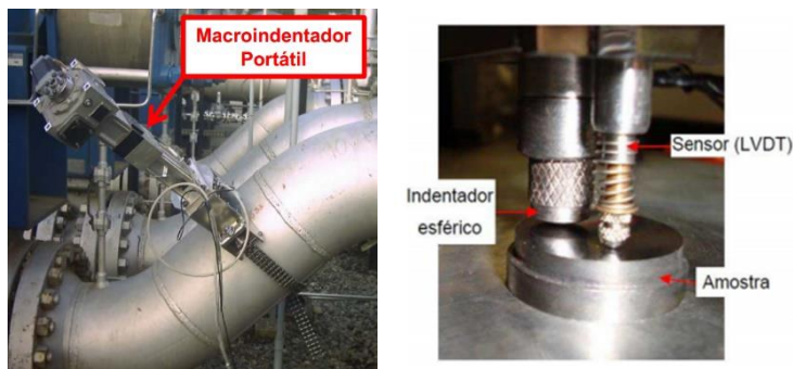
Figura 1: (a) Determinação de propriedades mecânicas de tração in situ em um duto de escoamento de petróleo utilizando um macroindentador portátil (Franco, 2007). (b) Posicionamento do penetrador e do sensor de deslocamento sobre a amostra (Ferreira, 2010).
