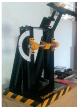
Figura 2: Máquina de Ensaio de Impacto Charpy utilizada.
