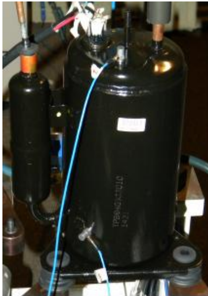
Figura 2: Acelerômetros posicionados nos pontos de medição do compressor de Duarte (2013)
