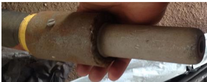
Figura 4: Conjunto de Mangueira (1 ¼ ") e Bico (5/16 ").
