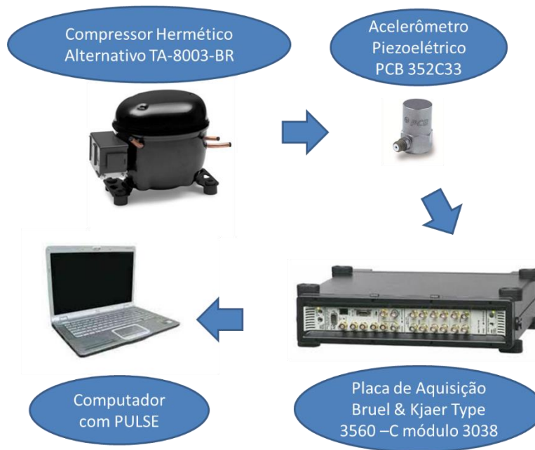
Figura 1: Esquema de montagem do aparato de experimental.
