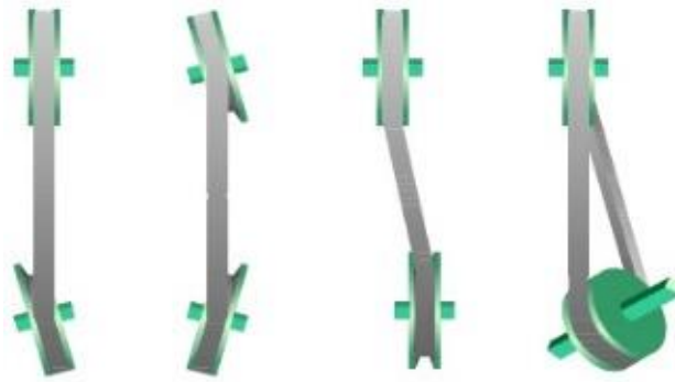
Figura 4: Desalinhamento de polias
