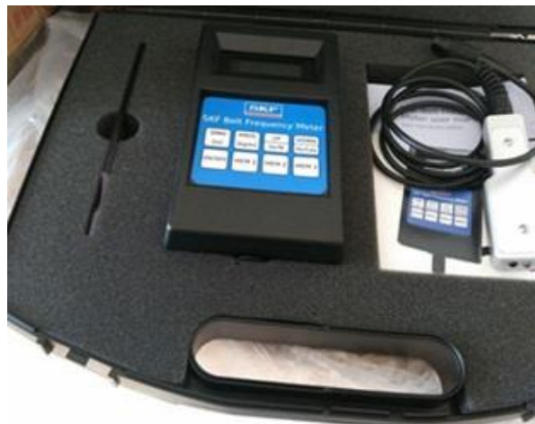
Figura 5: Tensionador de correias SKF Belt Frequency Meter
