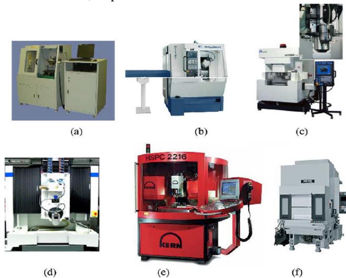
Figura 2: Máquinas-ferramentas comerciais de ultra precisão: (a) DT-110; (b) W-408 MT; (c) Hyper2j; (d) Kugler; (e) Kern; (f) Mori Seiki. (Adaptado de Chae, Park e Freiheit, 2006).
