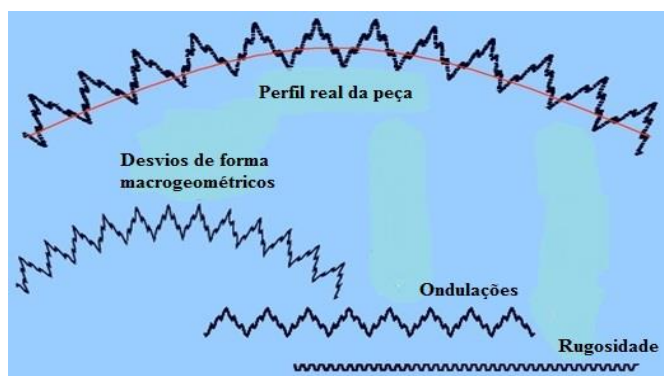
Figura 1: Desvios macrogeométricos e microgeométricos (Taylor Hobson, com modificações, 2003).
