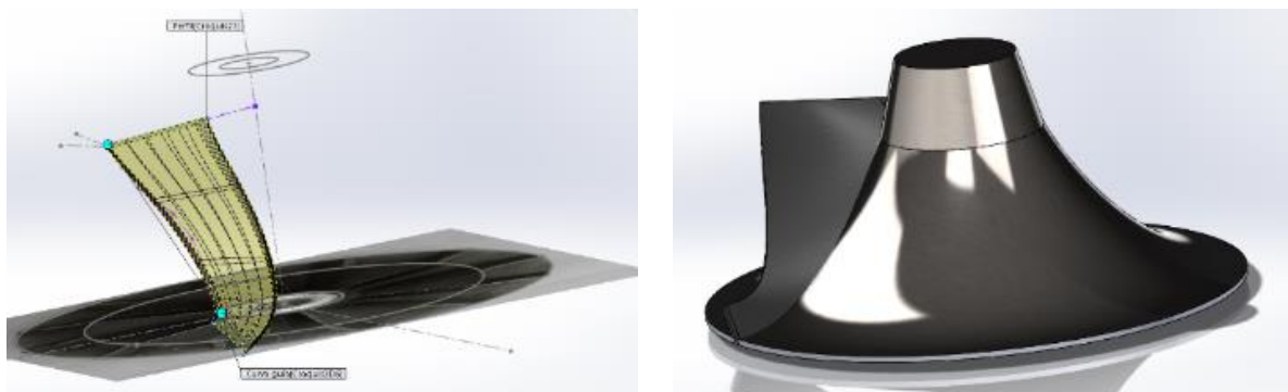
Figura 5: Geração da lâmina principal. Modelo em processo de digitalização.
