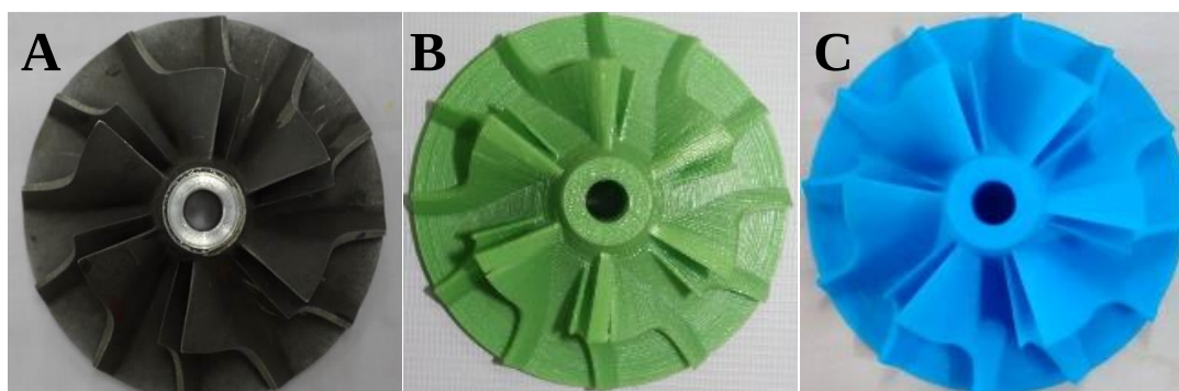
Figura 8: Vistas superiores do modelo original em comparação com os modelos impressos. A) Modelo original; B) Primeiro modelo impresso; C) Segundo modelo impresso, com correções de geometria.
