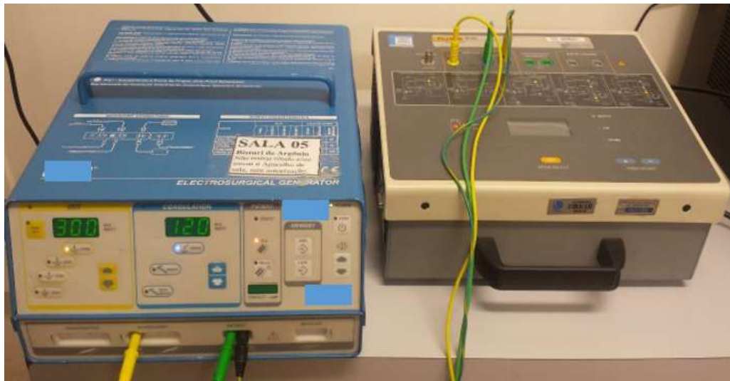
Figura 2: Bisturi elétrico (à esquerda) utilizado durante os experimentos, juntamente com o analisador de potência (à direita) do Fabricante A.
