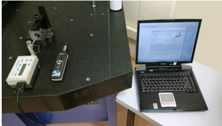
Figura 2: Rugosímetro portátil Surtronic 3+ da Taylor Hobson posicionado na mesa de desempenho da máquina de medir por coordenadas.
