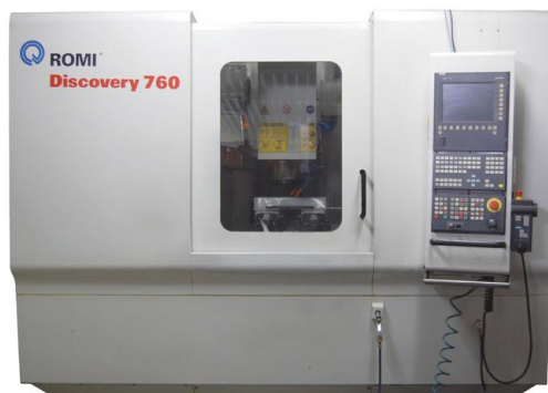
Figura 1. Centro de Usinagem CNC, marca Romi, modelo Discovery 760.
