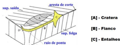
Figura 1. Principais tipos de desgaste de uma ferramenta de corte. (Adaptado de MACHADO, 2015)
